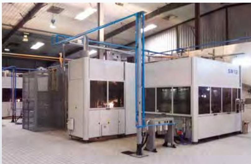
sono stati realizzati da Smimec, un'altra società del Gruppo SMI, utilizzando una sofisticata linea di produzione FMS composta da 12 centri di lavoro CNC. Questi ultimi sono macchine utensili tecnologicamente avanzate e completamente automatizzate, che funzionano 24 ore/24, 7 giorni la settimana, anche in assenza di operatori.
