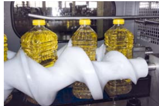
Sopra: il nuovo dispositivo all'ingresso del DV500 permette di orientare le bottiglie con maniglia nella posizione desiderata
