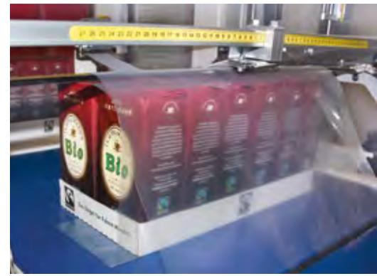
de aplicación y por el alto grado de personalización del proceso de embalaje. Respecto a la versión tradicional con barra soldadora, en la gama XP por lanzamiento de film la soldadura de los extremos superpuestos del film permanece en la parte inferior del paquete y no en los lados, lo que mejora considerablemente el aspecto estético de los paquetes realizados. Además, respecto a las versiones con barra soldadora, también es posible realizar paquetes con film impreso.
